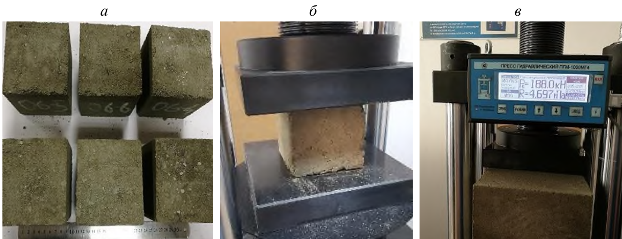
Рисунок 1 – Испытание образцов на прочность:
