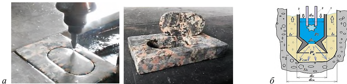
Рисунок 7 – Струйная технология разрушения твердых материалов:
