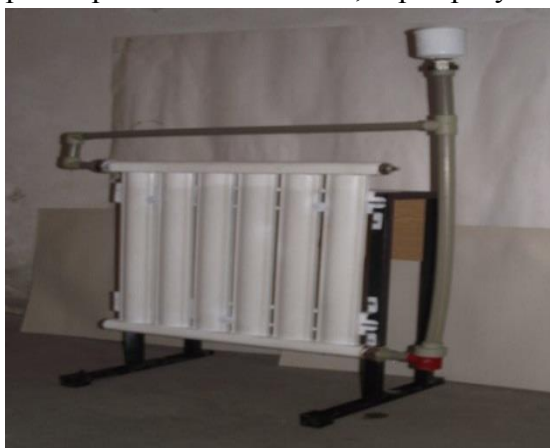
Рисунок 5. - Общий вид опытной системы обогрева помещений с ионно-электродным котлом.
