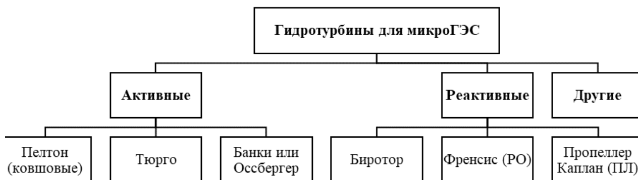
Рисунок 2 – Классификация гидротурбин для гидроэлектростанций класса микро
