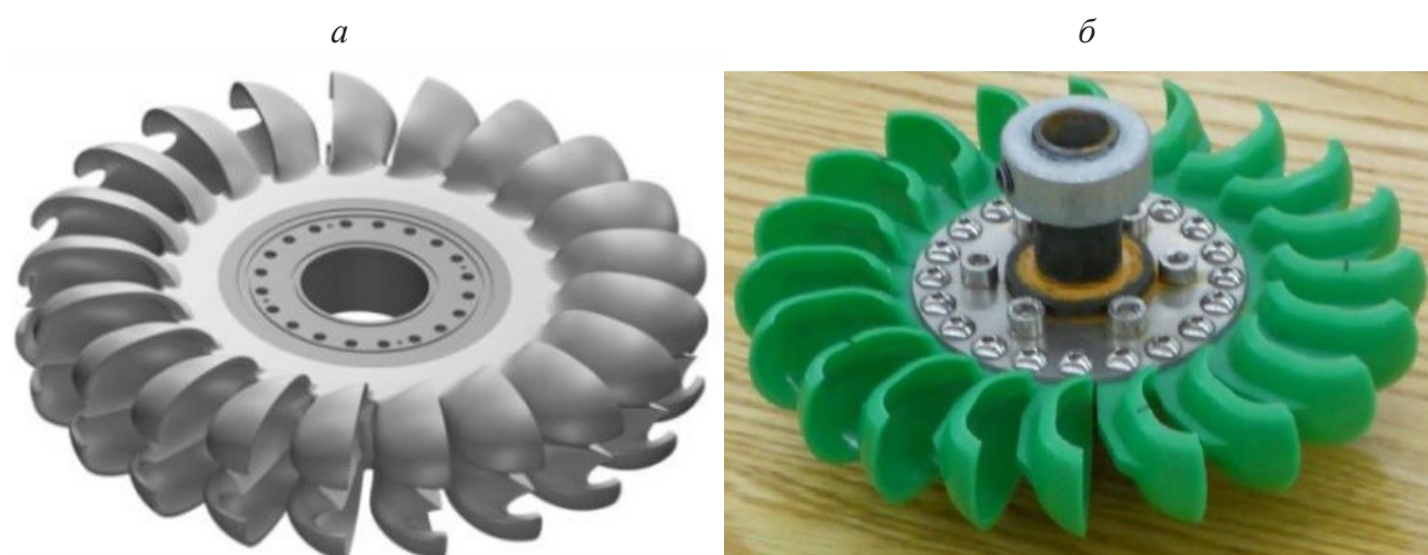
Рисунок 3 - Активные турбины: а - Ковшова турбина Пелтона; б - Турбина Тьюрго.
