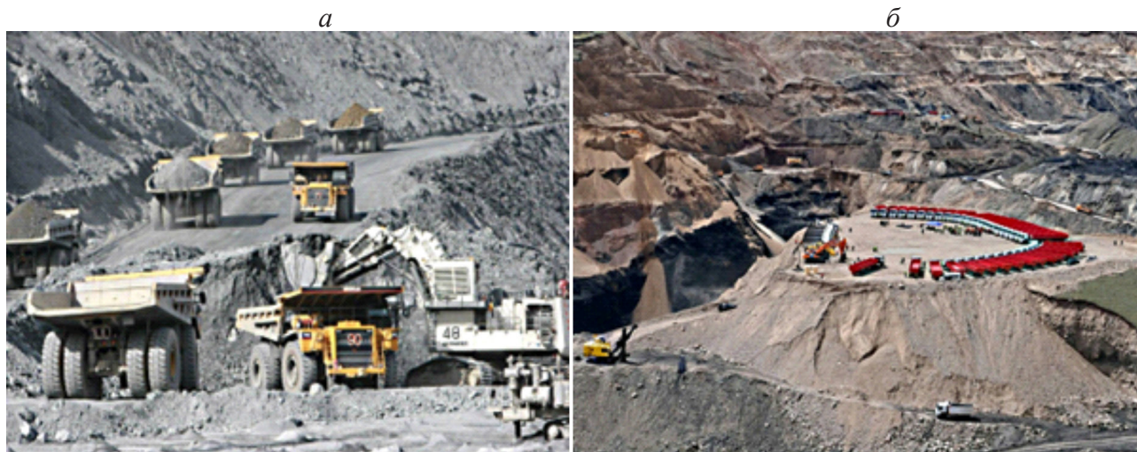
Рисунок 2 – Экскаватор и автосамосвалы – основная техника на карьерах КР: а - рудник «Кумтор»; б - карьер «Кара-Кече»
