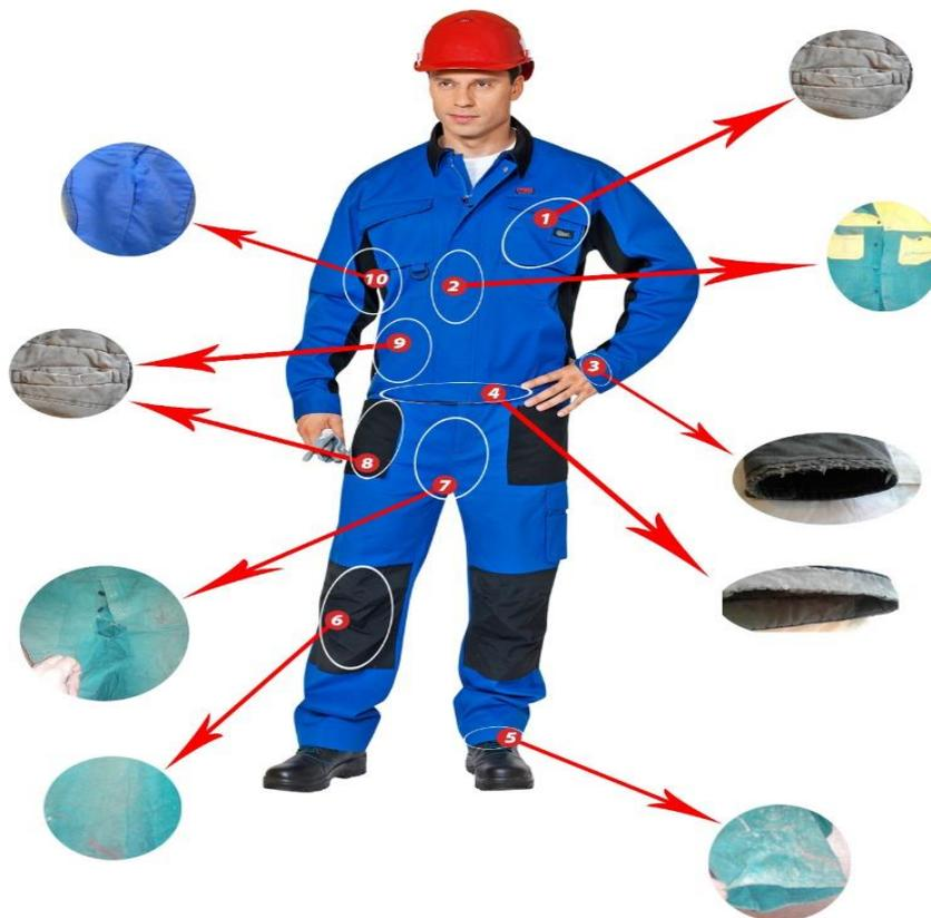
Рисунок1- Изнашивание участков специальной одежды в процессе эксплуатации
