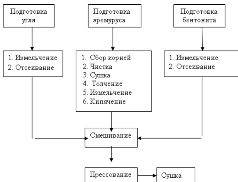
Рис. 1. Блок-схема технологии получения угольных брикетов с и со связующими из бентонитовой глины и продуктов эремуруса
