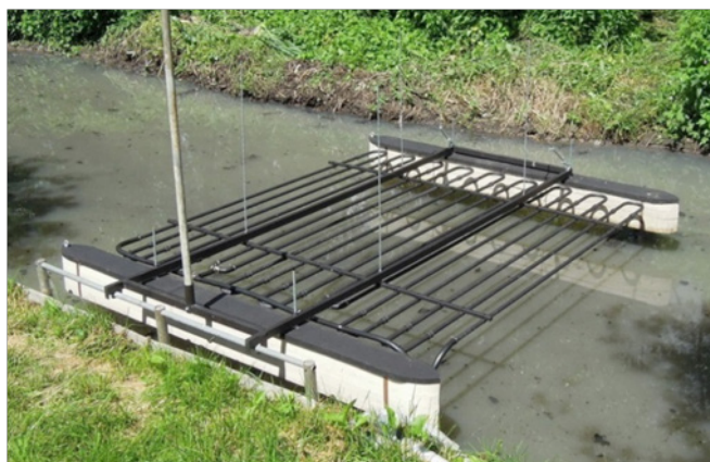
Рис. 5. Внешний вид экспериментального образца теплообменника, разработанного в ВИЭСХ.
