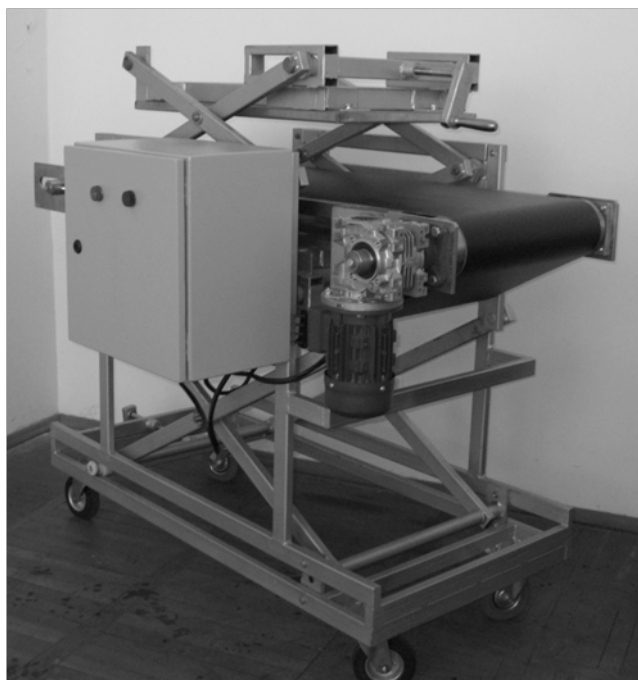
Рис. 1. Установка для магнитной обработки лука-севка.
