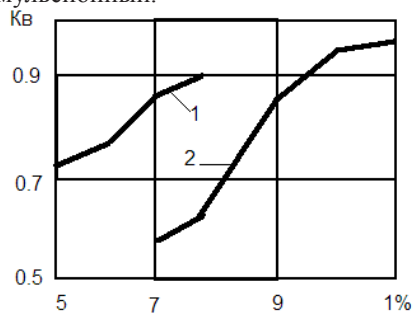
Рис. 1. Изменение предела прочности при сжатии R20 в зависимости от содержания гудрона Г и способа обработки:
