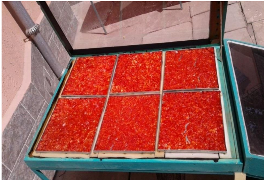
Рисунок 1 - Размещение поддонов с продуктами (томаты) в камере сушки ССУ с двухходовым движением теплоносителя
