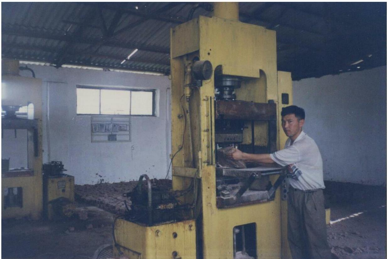
Рисунок 1 - Гидравлический камнекольный пресс ГКП-100
