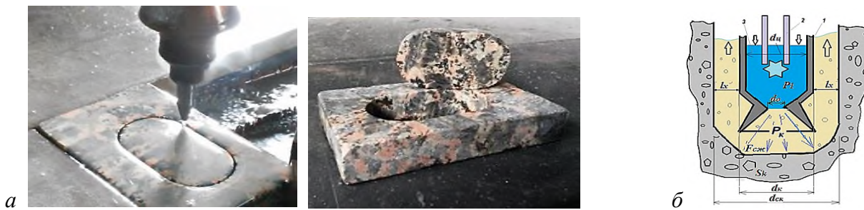
Рисунок 7 – Струйная технология разрушения твердых материалов:
