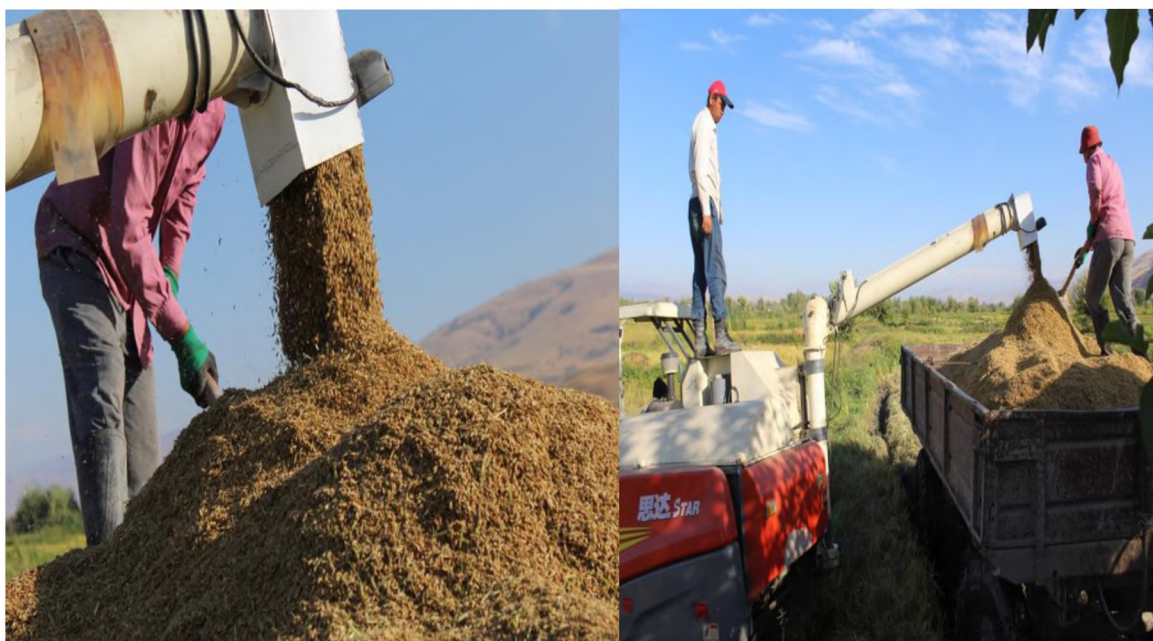
Рисунок 12 - Выгрузка зерновки шалы прямого комбайнирования на тракторную тележку растения риса прямым комбайнированием в основном отказались от этого способа.
