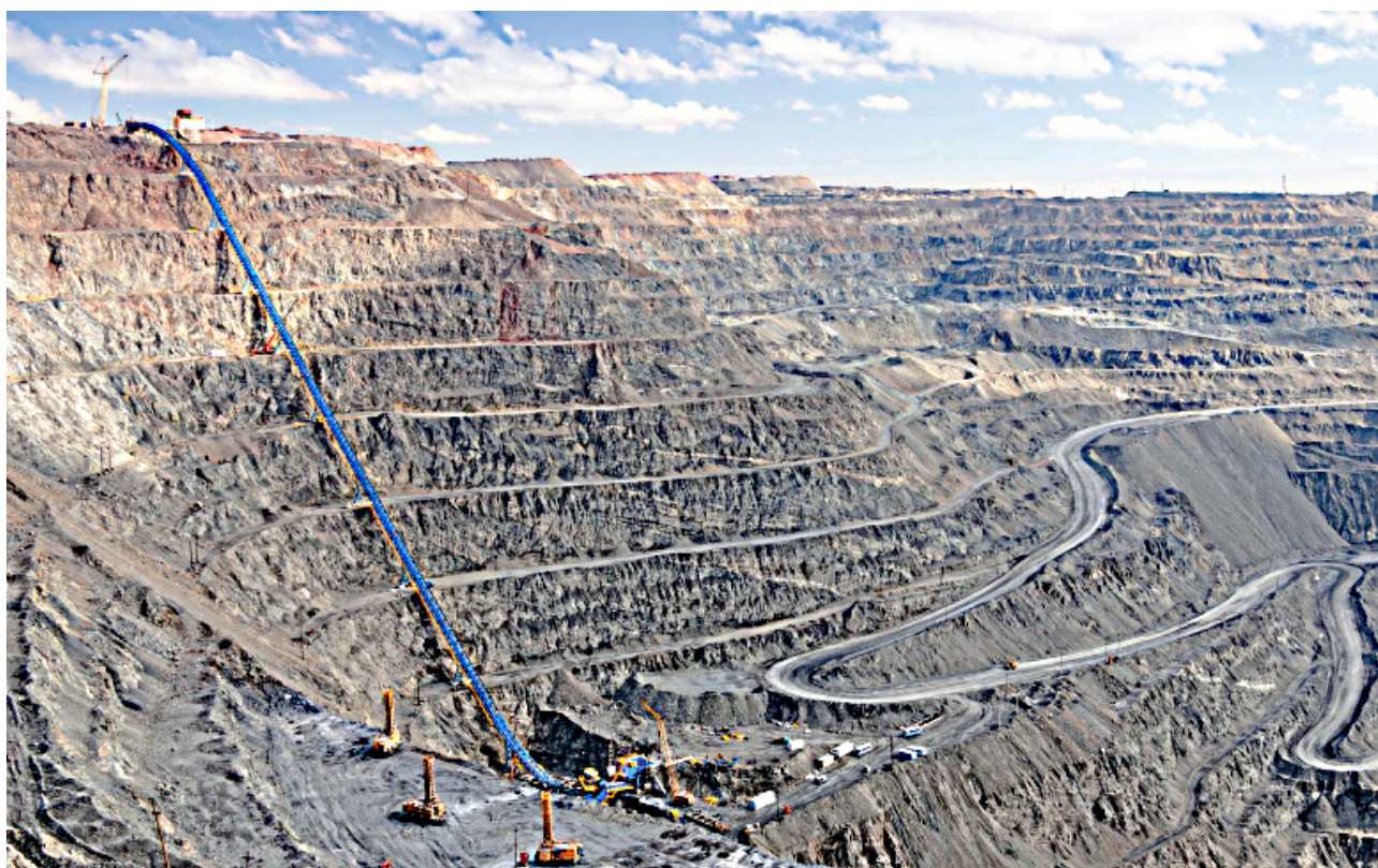
Рисунок 5 – Общий вид карьера «Мурунтау» с крутонаклонным конвейером
